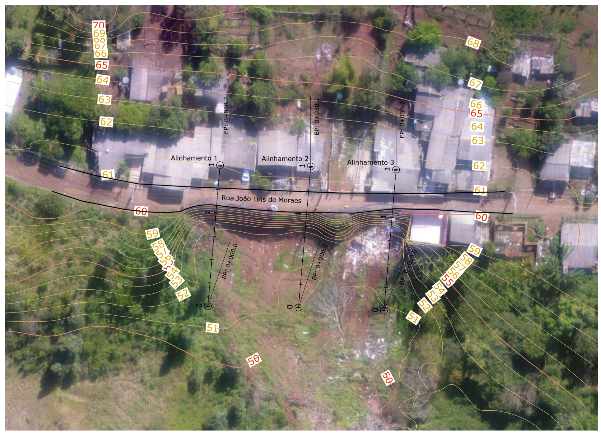
Implantação Terraplanagem - Situação Atual Escala 1:500
