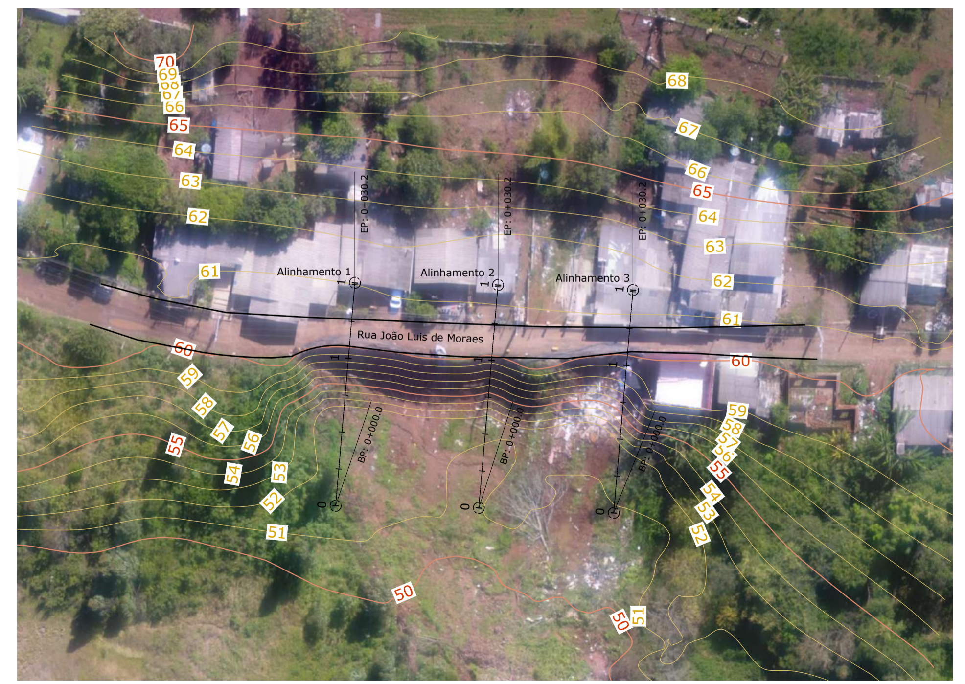
Implantação Terraplanagem - Situação Futura Escala 1:500
